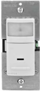
Sensor Universal Encendido automático 120V~ 60Hz 180° PIR 150W LED / CFL 300W Incandescente 1/6 hp 2.5A 1 Polo Encendido relay Requiere tierra Cat. IPS02
