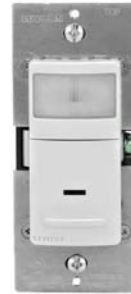
Sensor Universal Encendido automático 120V~ 60Hz 180° PIR 150W LED / CFL 600W Incandescente 1 Polo / 3 vías Encendido Triac No Requiere tierra Cat. IPS06
