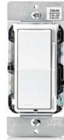
Interruptor Decora sencillo / 3 vías con barra para atenuación lateral 1000W incandescente 450W LED 450W Ahorradores 120V~ Cat. DSM10-1LZ
