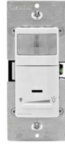
Sensor Universal Con atenuador Encendido automático 120V~ 60Hz 180° PIR 150W LED / CFL 600W Incandescente 1 Polo / 3 vías Encendido Triac No Requiere tierra Cat. IPSD6
