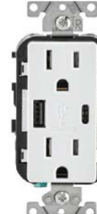
2 Puertos USB Tipo C / Tipo A, 5.1A 5VDC y receptáculo dúplex Tamper Resistant 15A-125V~ Cat. T5633
